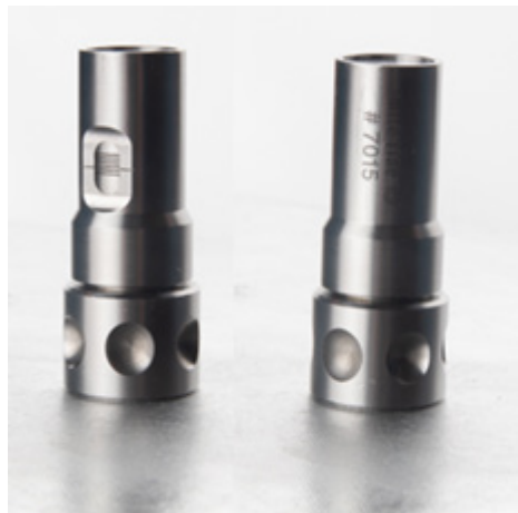
Figura/Figure 1: Aparelho Smile Line #7015, Suíça- Ajuste do equipamento para que todos os discos confeccionados, apresentassem 2mm de espessura, sendo que o diâmetro do equipamento é sempre constante - 10mm. Assim avalia-se equitativamente os três materiais em estudo tendo em conta a espessura e o diâmetro, sendo fatores condicionantes/ Smile Line #7015, Switzerland - Adjustment of the equipment so that all the discs made were 2mm thick, with the diameter of the equipment always constant - 10mm. In this way, the three materials under study were evaluated equally, taking thickness and diameter into account as conditioning factors.
